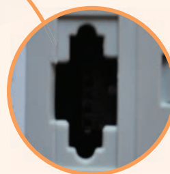
→ Разъем для подключения дополнительных модулей
