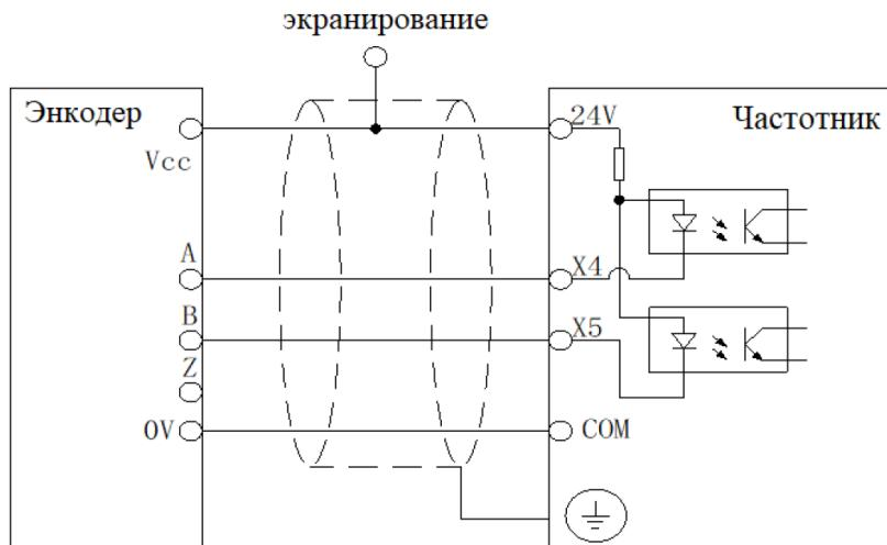
Вышеуказанная схема – это способ подключения энкодера для Push-Pull выхода или выхода по напряжению. Напряжение питания энкодера 24 В и рекомендуемое питание для входной оптопары преобразователя 24 В. Примечание:
