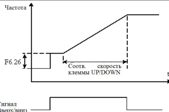
Рис.6-19 Начальный шаг клеммы UP/DOWN
