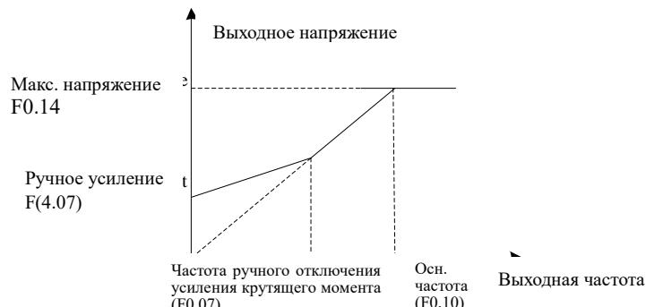
Рис.6-10 Схема усиления крутящего момента
