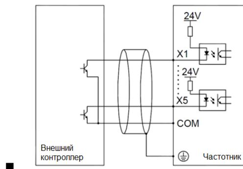
Рис. 3-12 Стандартный способ подключения NPN с помощью проводов эмиттера
