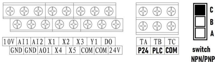
Рис. 3-10 Расположение клемм цепи управления для версии B2\_0102
